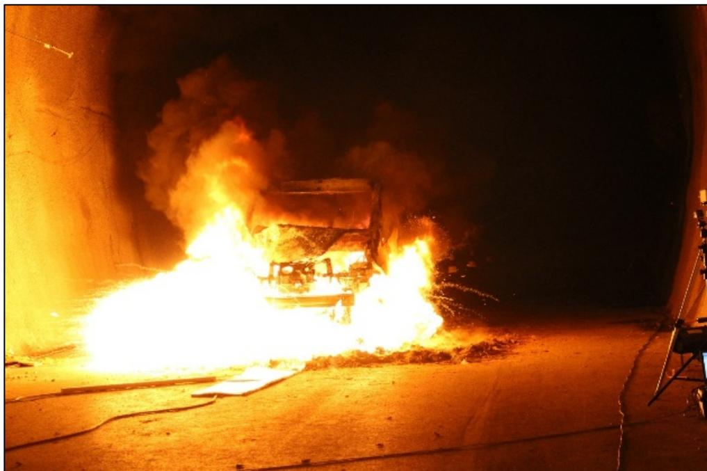
**Abbildung 7: BV02 Vollbrand Fahrzeug und Batterie**
