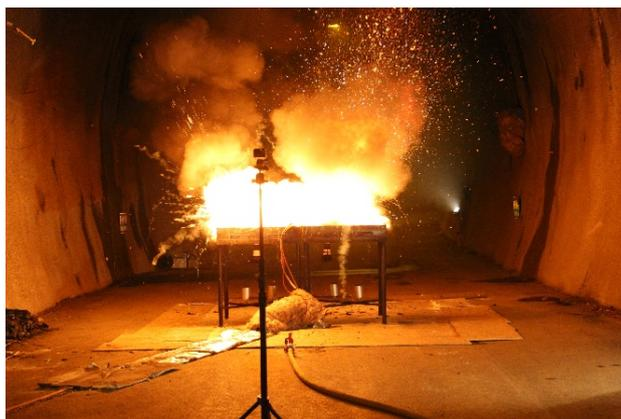
**Abbildung 5: Brandversuch vollständige Batterieanordnung PKW (17 Module)**
